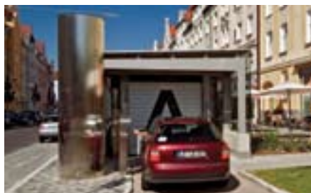
Le aree di entrata (A, B, C e D) sono accessibili a livello strada. L'utente attiva la procedura di parcheggio con il proprio chip induttivo al pannello di comando posizionato di fronte all'area di entrata.
