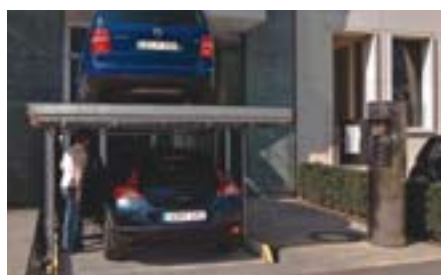
L'utente parcheggia l'auto sulla piattaforma e scende. Tramite la pulsantiera abbassa l'impianto fino a quando la piattaforma raggiunge il livello terra.
