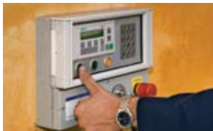
Uno speciale pannello di controllo con chiave di accesso, display, numeri digitali, tasti di salita/discesa, messaggio di errore e tasto di emergenza per gestire le unità di fianco e di fronte all'altra.
